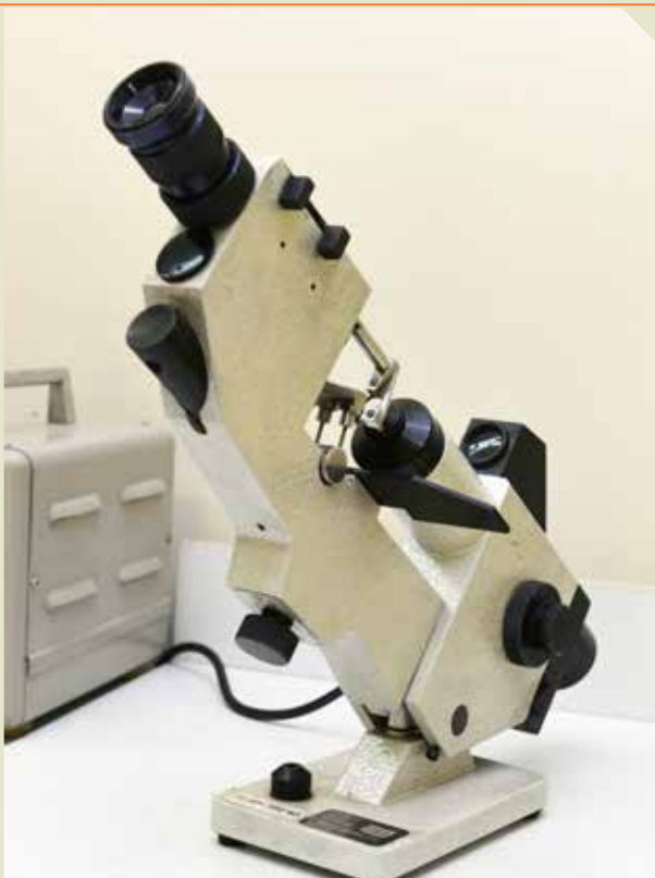
دستگاه لنزومتر برای اندازه‌گیری توان دیوپتوی عدسی که در این مرکز ساخته شده است
