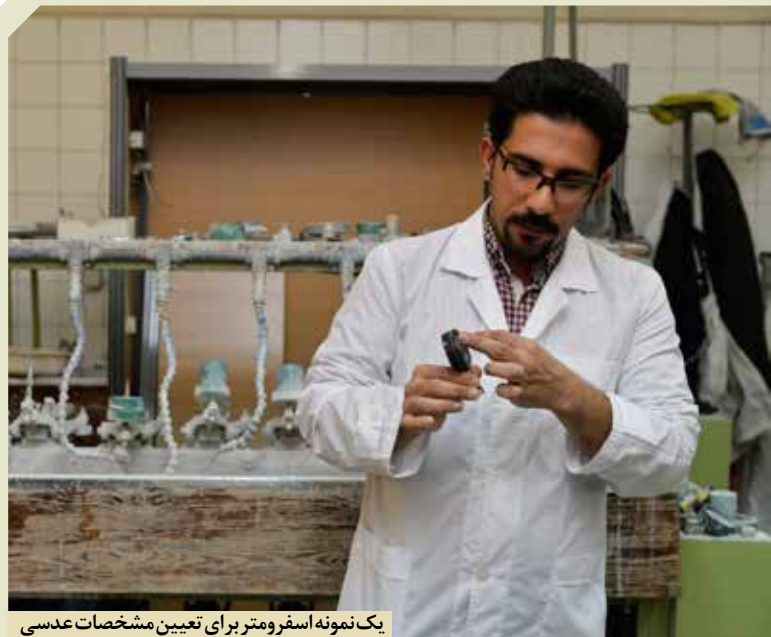
یک نمونه اسفرومتر برای تعیین مشخصات عدسی
